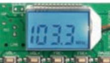
FM-Transmitter-Modul mit Stereodekoder, Line-Eingang, Mikrofon und digitaler Frequenzanzeige
