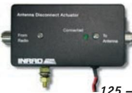
Der Antenna Disconnect Actuator (DCA) von INRAD trennt die Antenne automatisch vom Transceiver und erdet sie. So schützt er vor Schäden durch Blitze usw.
