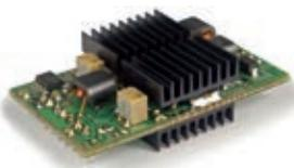
Bausatz nach H. Arnold, DL2EWN, (FA 2/2016) für einen besonders intermodulationsarmen 5-W-Linearverstärker (Gp=23 dB) bestehend aus einer SMD-vorbestückten Platine sowie allen erforderlichen aktiven und passiven Bauelementen sowie 4 Kühlkörpern.
