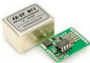
FA-SY 1-Bausatz für einen USB-steuerbaren Universal-Oszillator für Frequenzen von 10 bis 160 MHz. Herzstück ist ein SiLab-IC Si570 in CMOS-Version ( $\pm 31,5$  ppm, mit der On-board-Heizung reduzierbar). Größe 36 x 27 x 19 mm, alle SMD-Teile bestückt. Stromversorgung über USB oder/und 12 V extern. Die FA-SY 2 und 3 basieren auf einem Si570 mit LVDS-Ausgang.
