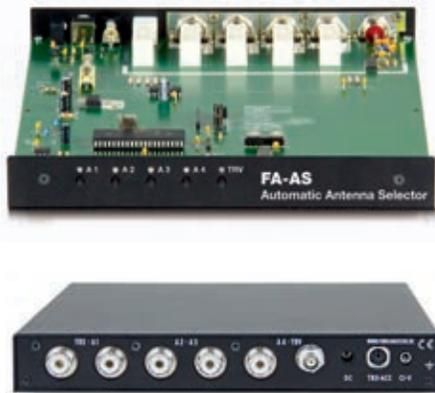
Der „Automatic Antenna Selector“ ermöglicht es, vier verschiedene Antennen an den IC-7300 anzuschließen und je nach Betriebsfrequenz automatisch zu wählen. Die Programmierung erfolgt intuitiv, wobei 2-Farb-LEDs den Schaltzustand der Antennenrelais signalisieren.
